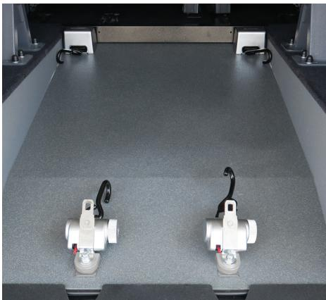
**Sistemas de seguridad** delanteros eléctricos y traseros manuales.
