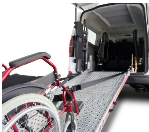
Anclajes extra largos para la sujeción de la silla de ruedas.
