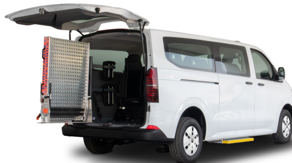
Rampa manual pivotante para facilitar el acceso de equipaje.
