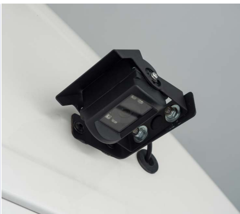
Cámaras de visualización en el exterior situadas en la puerta lateral y en la puerta trasera
