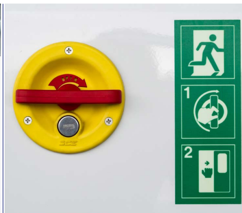
Sistema de apertura de emergencia de la puerta lateral situado en el exterior
