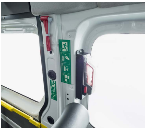
Sistema de apertura de emergencia de la puerta lateral situado en el interior
