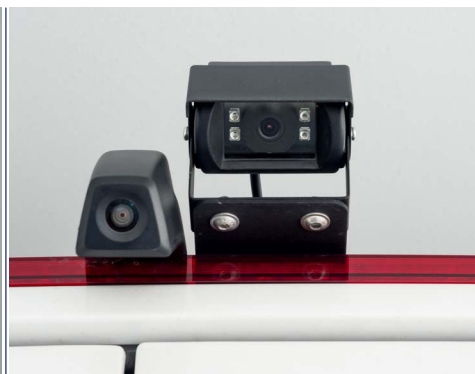
Cámaras de visualización en el exterior situadas en la puerta lateral y en la puerta trasera
