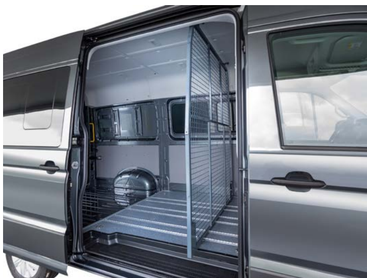
Asientos desmontables quick fix. Rejilla en posición para capacidad máxima de carga.
